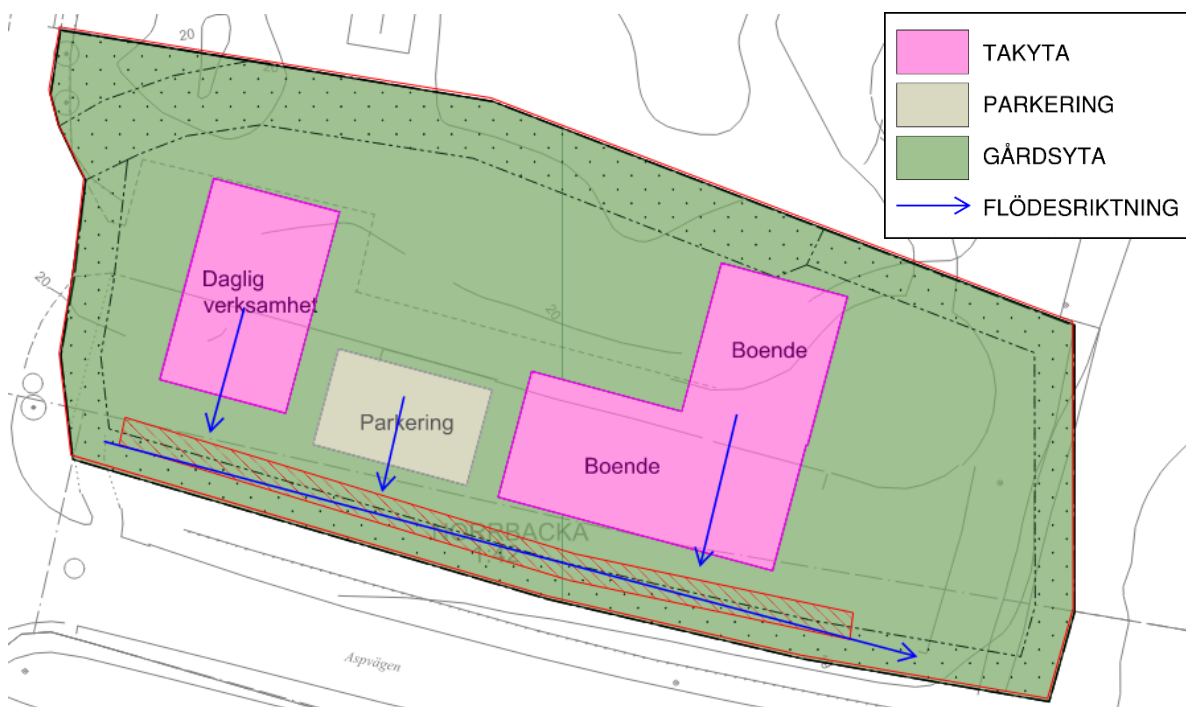
Figur 9. Avvattningsplan vid skyfall med ungefärlig planerad utformning av utredningsområdet.
