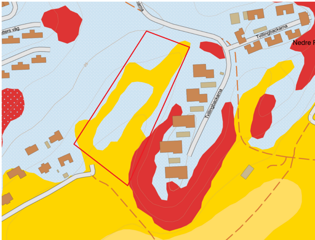
Figur 3. SGU:s jordartskarta, där gul är glacial finlera, blå-vit är sandig morän och rött är urberg (berg i dagen). Rubricerat område är ungefärligt markerat med röd figur.
