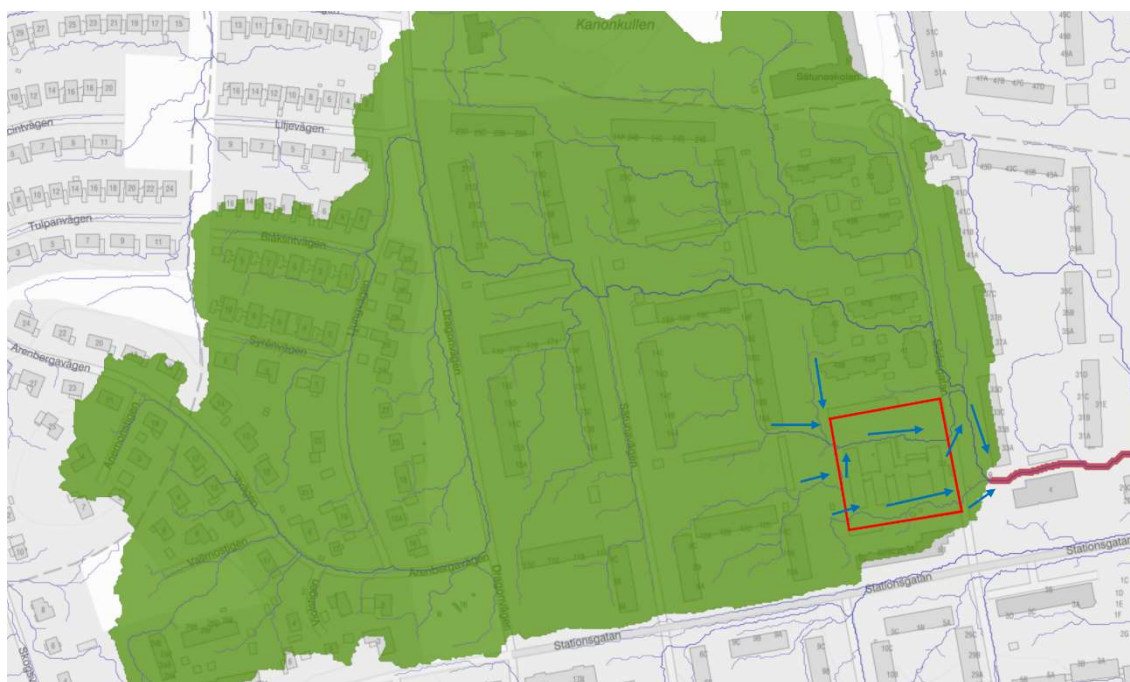
Figur 10. Planområdets avrinningsområde (grönt). Planområdesgränsen är markerad i rött. Blåa pilar illustrerar riktning för ytlig avrinning. Bild från SCALGO Live, med höjddata från Lantmäteriet.
