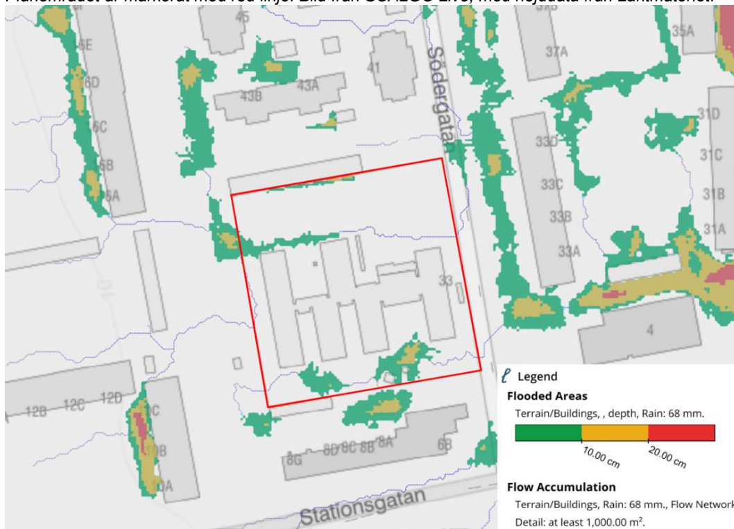
Figur 14. Vattendjup vid befintliga lågpunkter inom och i närheten av planområdet vid 68 mm regn. Planområdet är markerat med röd linje. Bild från SCALGO Live, med höjddata från Lantmäteriet.
