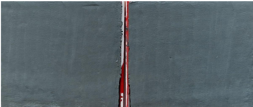
Figur 3 Borrpunkten, 23B04, 8,0 m, Jordprovet i nedre delen av mellanhylsan delad longitudinellt provhylsan med id Bjerking 901.
