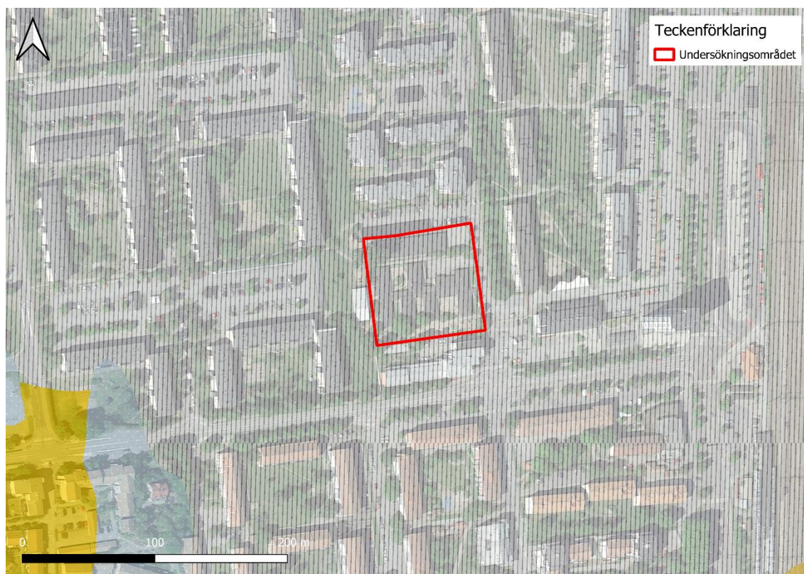
Figur 3. Utdrag från © SGU:s jordartskarta med undersökningsområdet. Gul färg representerar (glacial/postglacial) lera, blåvitprickiga områden visar sandig morän medan de gråstreckade områden representerar fyllning. © SGU
