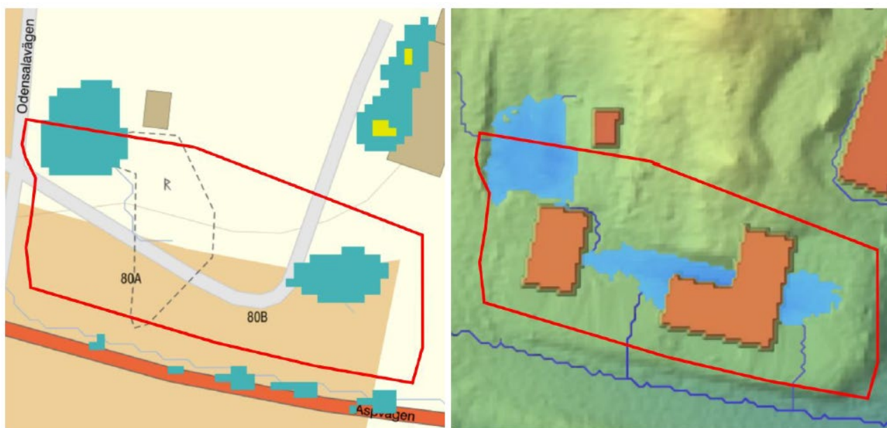
Figur 2 T.v. Skyfallskartering för ett 100-årsregn från Länsstyrelsen Stockholms län (2021). T.h. Skyfallmodell i Scalgo Live med den planerade placeringen av huskropparna. Utredningsområdets ungefärliga gräns markerad med röd polygon i båda figurer.
